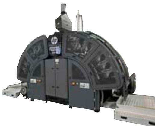
HPs PageWide T240 HD hat eine Druckbreite von bis zu 521 mm und druckt mit einer Geschwindigkeit von bis zu 152 m/min.
