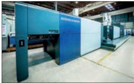
*Das modulare Konzept der VariJET ermöglicht die Kombination von Inkjetdruck mit Druck- und Inline-Veredlungsmöglichkeiten.*
