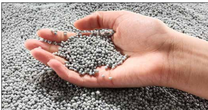
Mithilfe von Recosys 2.0 können überschüssige Trägermaterialien aus der grafischen Industrie nun erstmals zu recyceltem PET (rPET) verarbeitet werden.
