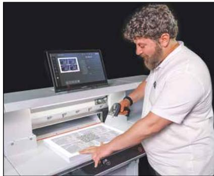
**Für die Übertragung des in Speedcut erzeugten gesamten Schneidprogramms per QR-Code kann dieser als Deckblatt gedruckt werden und wird an der Maschine per Handscanner eingelesen.**
